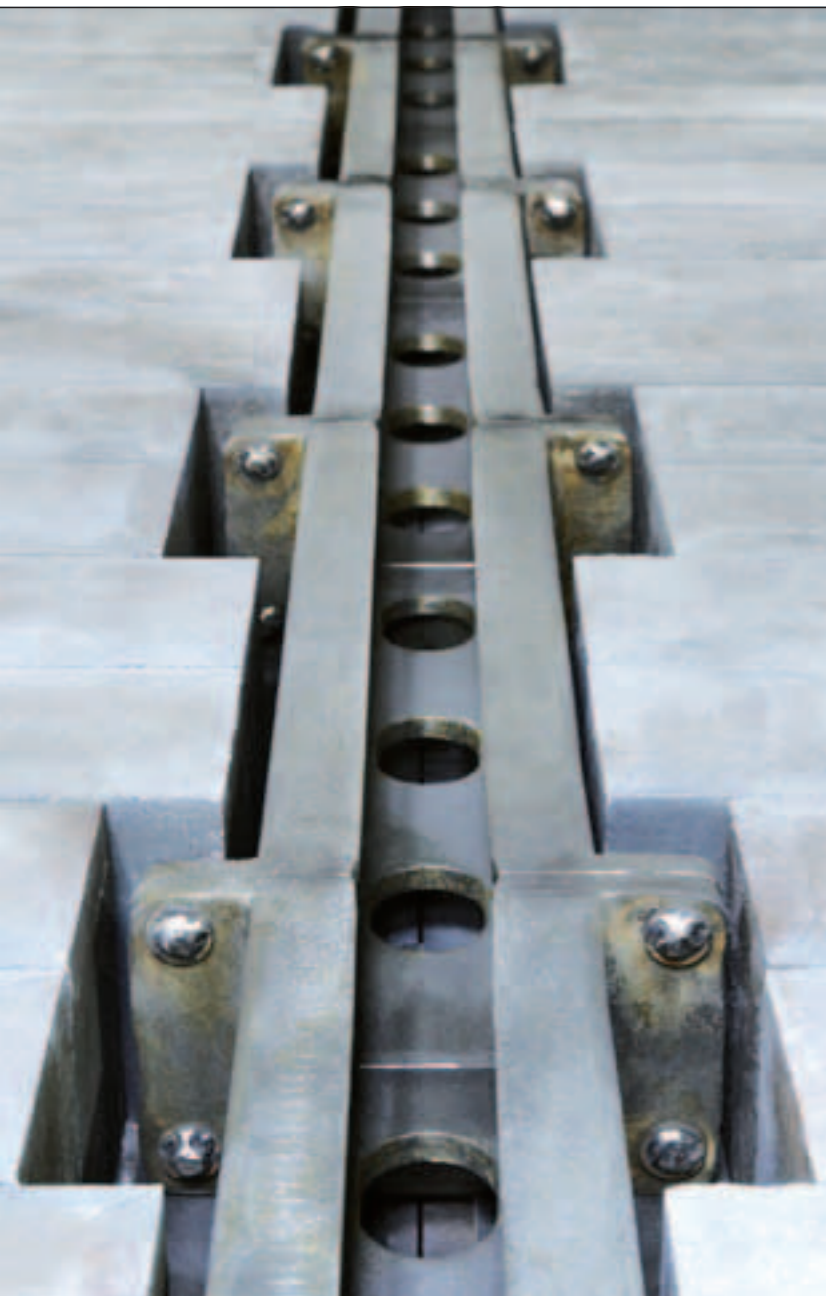
Führung der Querstoßerkette in einem Durchstoßofen
