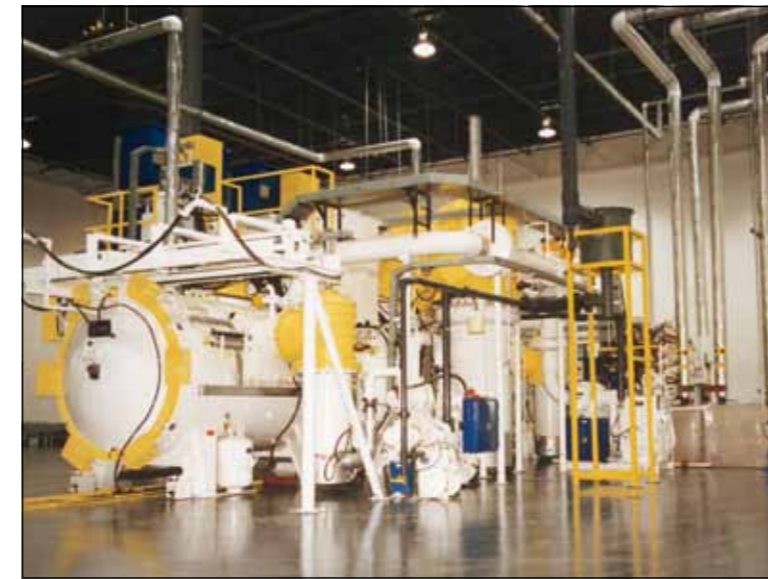
Drei-Kammer-Durchlauf-Vakuum-Lötofen für die Großserienproduktion
