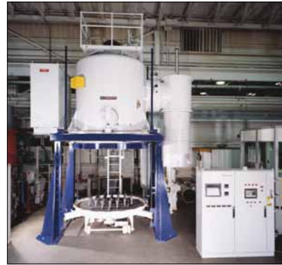
Vertikaler Vakuum-Lötofen für Großkomponenten z. B. aus dem Luftfahrtbereich
