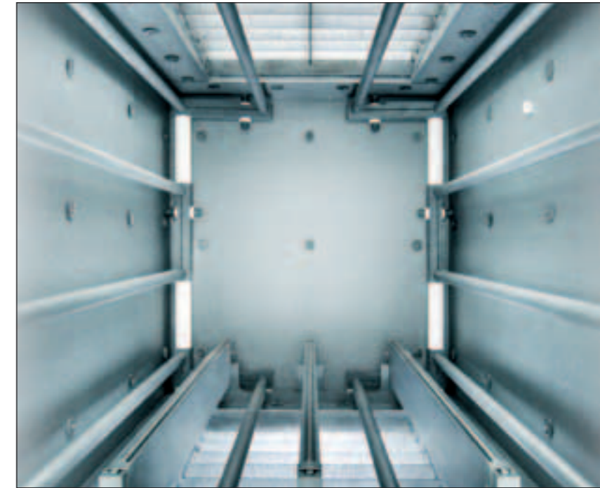
Ipsenの革新的なガス整流格子付き炉室
