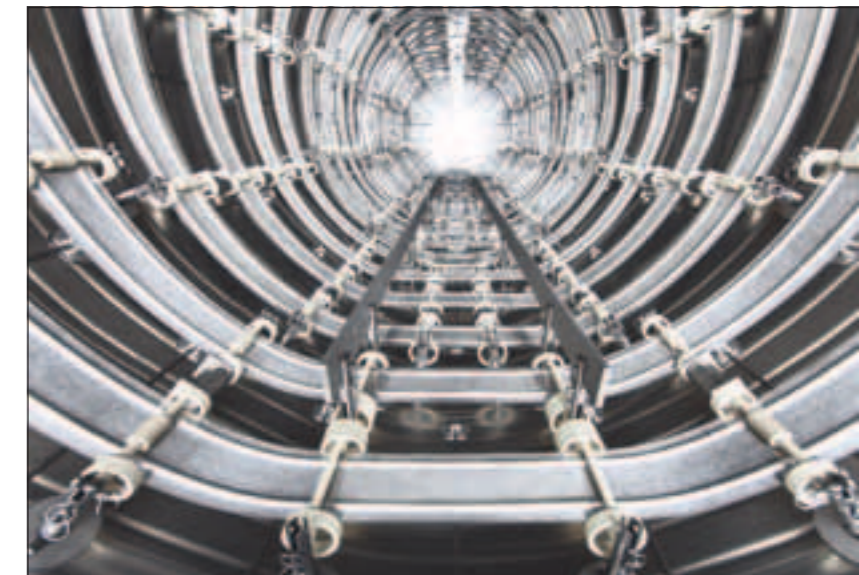
硬ろう付けと高温ろう付け用の新 Ipsen 燃焼室
