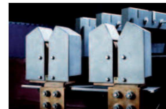
Подвод тока в вертикальной Вакуумной печи
