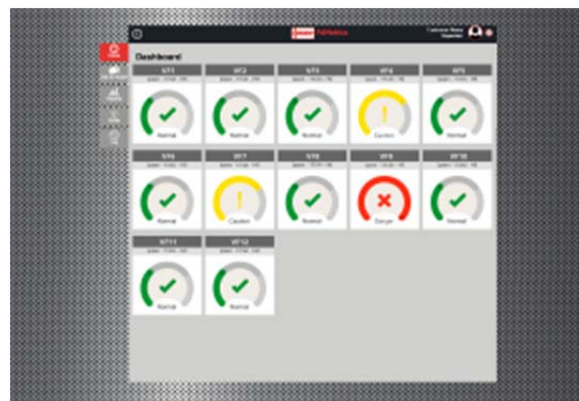
Abbildung 5: Über das Dashboard können mehrere Öfen gleichzeitig überwacht werden. Sobald eine Maßnahme erforderlich wird oder eine Störung auftritt, wird dies durch ein gelbes Warnsymbol oder durch ein rotes Gefahrensymbol angezeigt.
